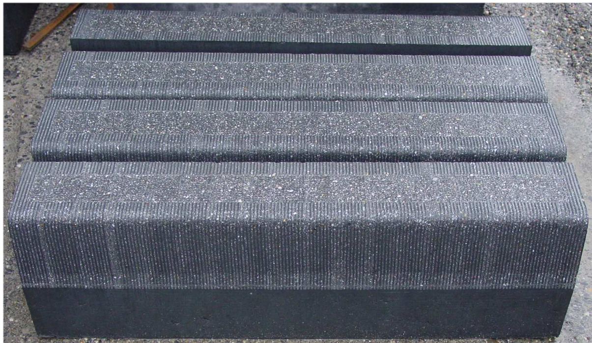
Figuur 4: Gefrijnde en gepunthamerde boordstenen in imitatie natuursteen
